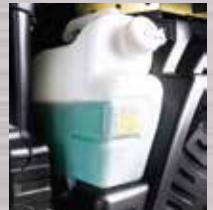
Tangki Radiator Posisi di bagian luar sehingga mudah dikontrol.
